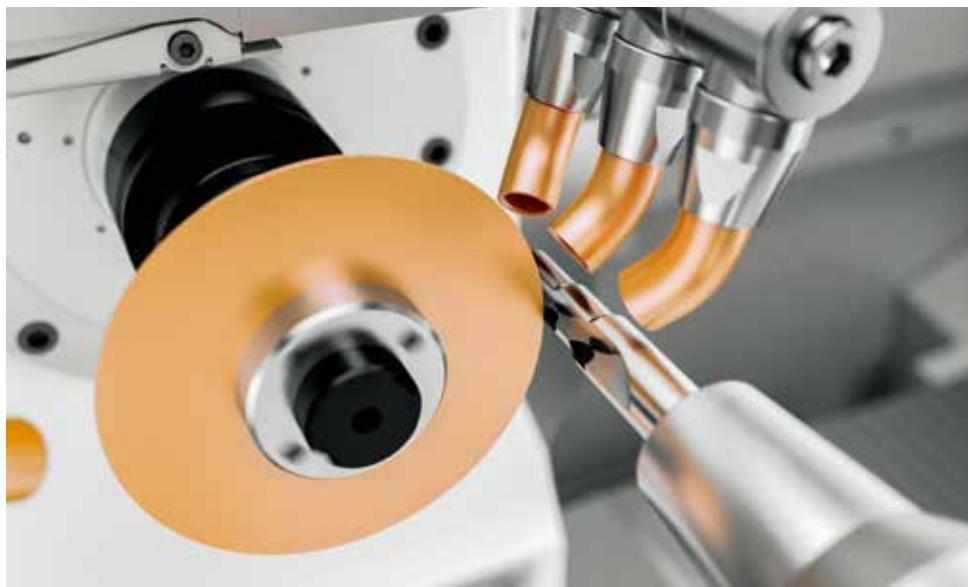
//////// USINAGE D'UN FORET PCD ÉTAGÉ
