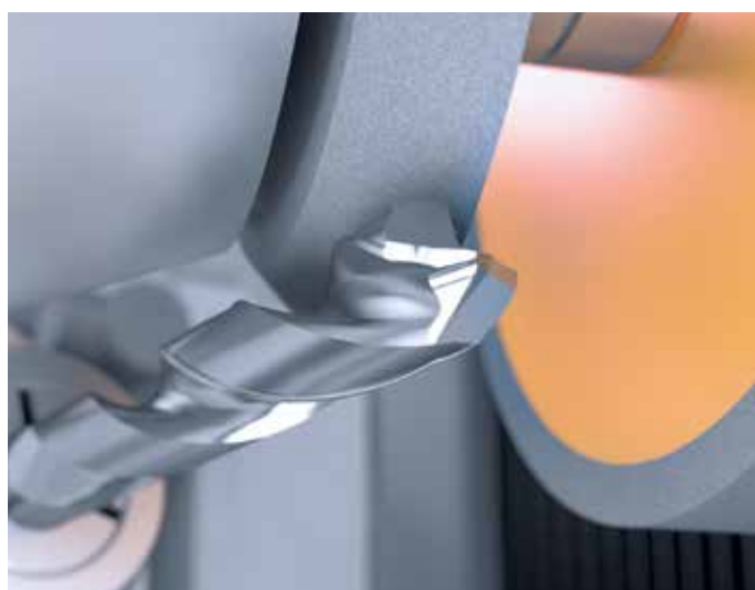
/// USINAGE DE FORETS CARBURE
