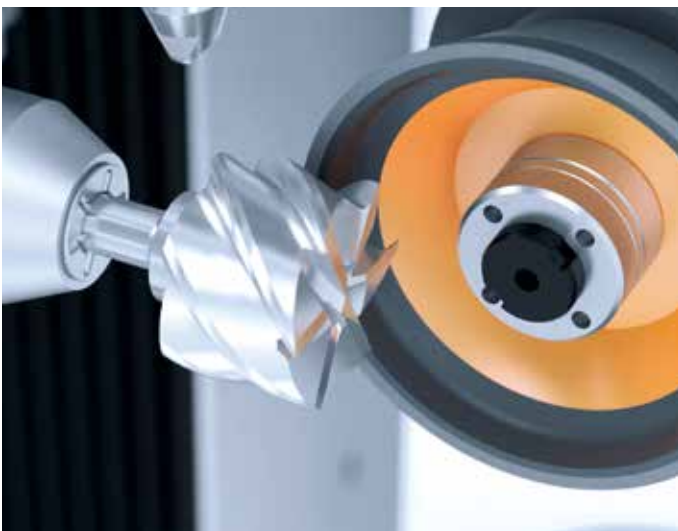
/// MECANIZADO DE FRESAS DE METAL DURO
