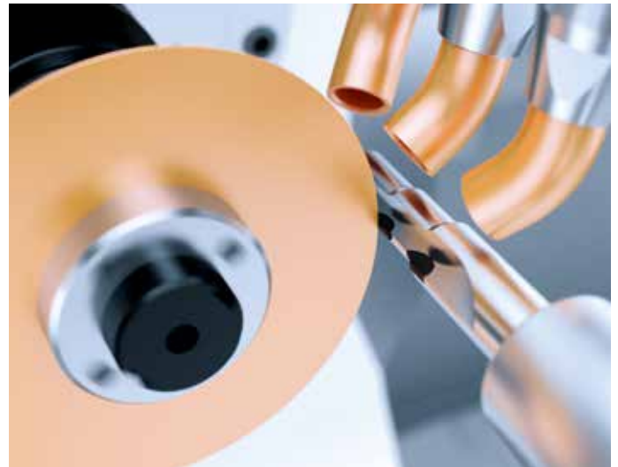
/// MECANIZADO DE UNA BROCA ESCALONADA DE PCD
