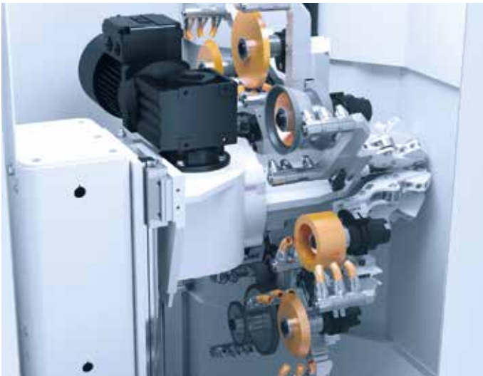
/// CAMBIADOR DE 8 POSICIONES CON NUEVOS CONJUNTOS DE LIMPIEZA
