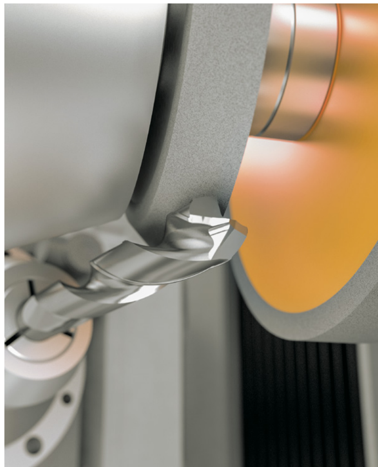
//////// BEARBEITUNG VON HARTMETALL-BOHRERN
