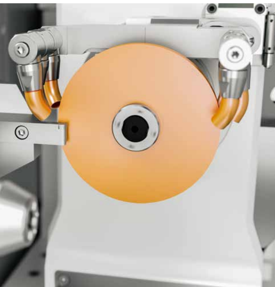
////// DISPOSITIVO PARA RETIFICAR OS ELETRODOS
