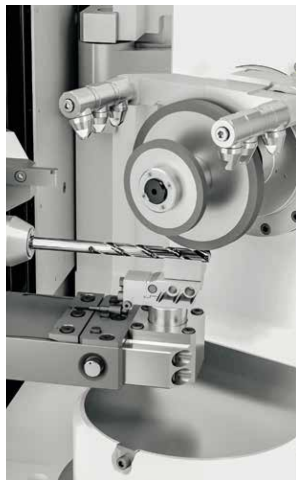
////// LUNETAS COM LEVANTAMENTO AUTOMÁTICO garante um resultado de afiação ideal em ferramentas mais compridas
