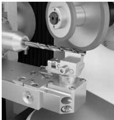
//////// SYSTÈME DE LUNETTE À MONTÉE AUTOMATIQUE pour un résultat d'affûtage optimal sur les outils longs
