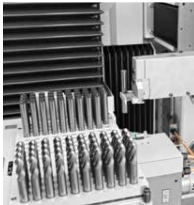
//////// CHARGEUR INTERNE À PALETTES pouvant contenir jusqu'à 300 pièces brutes ou outils
