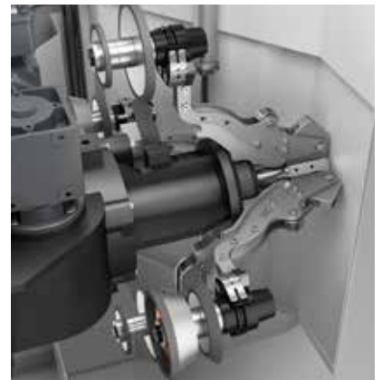
//////// CHANGEUR DE MEULES À 4 POSITIONS pour un changement efficace des trains de meules et une diminution des temps morts
