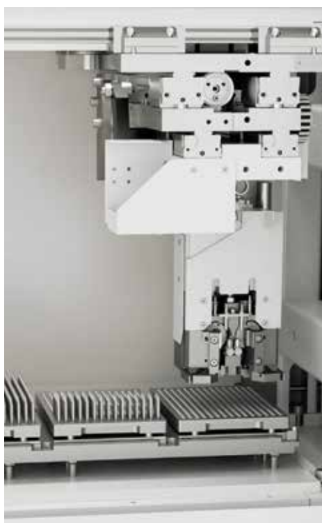
////// MAGAZYN PALETOWY HP 160 do szybkiego doprowadzania nawet 900 narzędzi
