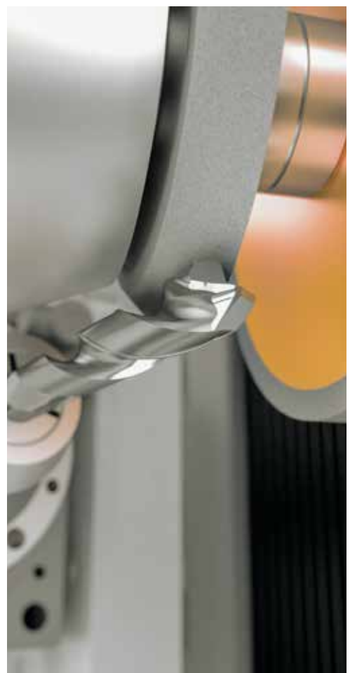
///// BEARBEITUNG VON HARTMETALL-BOHRERN
