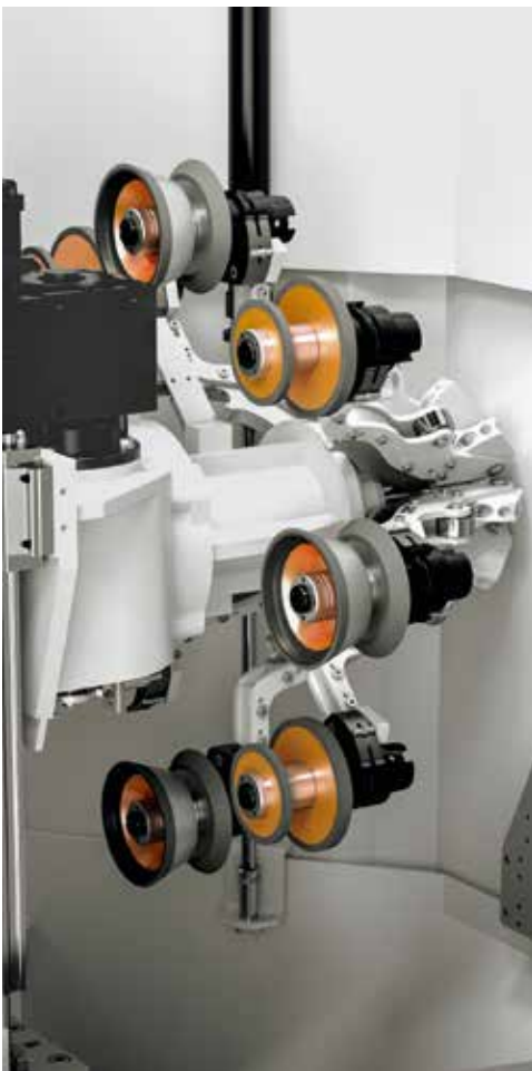
/////// 8-FACH-SCHLEIFSCHEIBENWECHSLER für effiziente Schleifscheibenwechsel und Reduktion der Nebenzeiten
