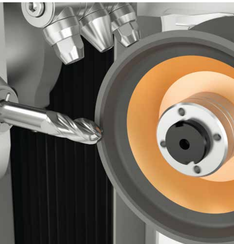
///// BEARBEITUNG VON HARTMETALL-FRÄSERN
