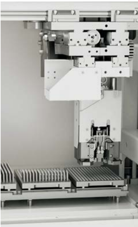
////// 托盘库 HP 160 用于快速供给最多 900 个刀具
