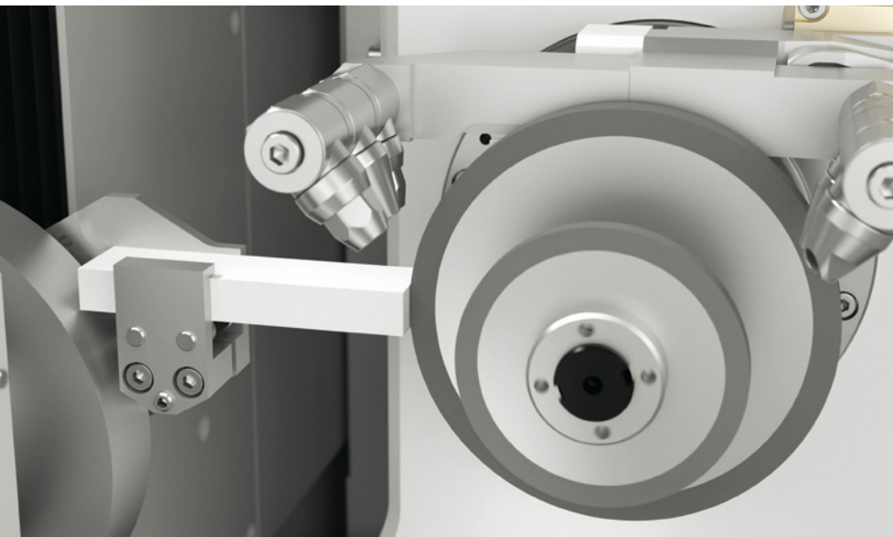
//////// AUFRAUH-EINHEIT zum Öffnen des Schleifbelags
