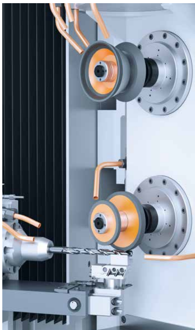
/// LUNETTA per un dosaggio preciso della contropressione durante l'affilatura del pezzo
