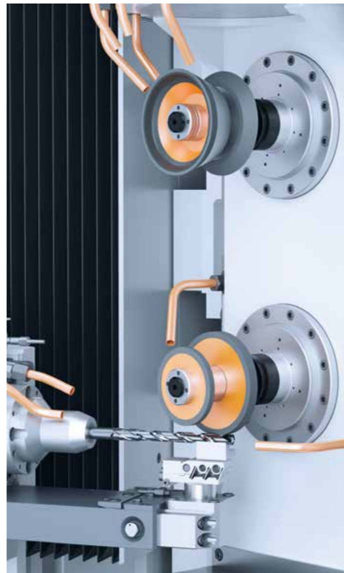
/// LÜNETTE für exakt dosierten Gegendruck beim Werkzeugschleifen
