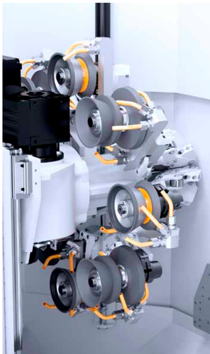
//// AUTOMATYCZNA WYMIANA PAKIETÓW ŚCIERNIC DLA 8 POZYCJI razem z dyszami chłodzącymi
