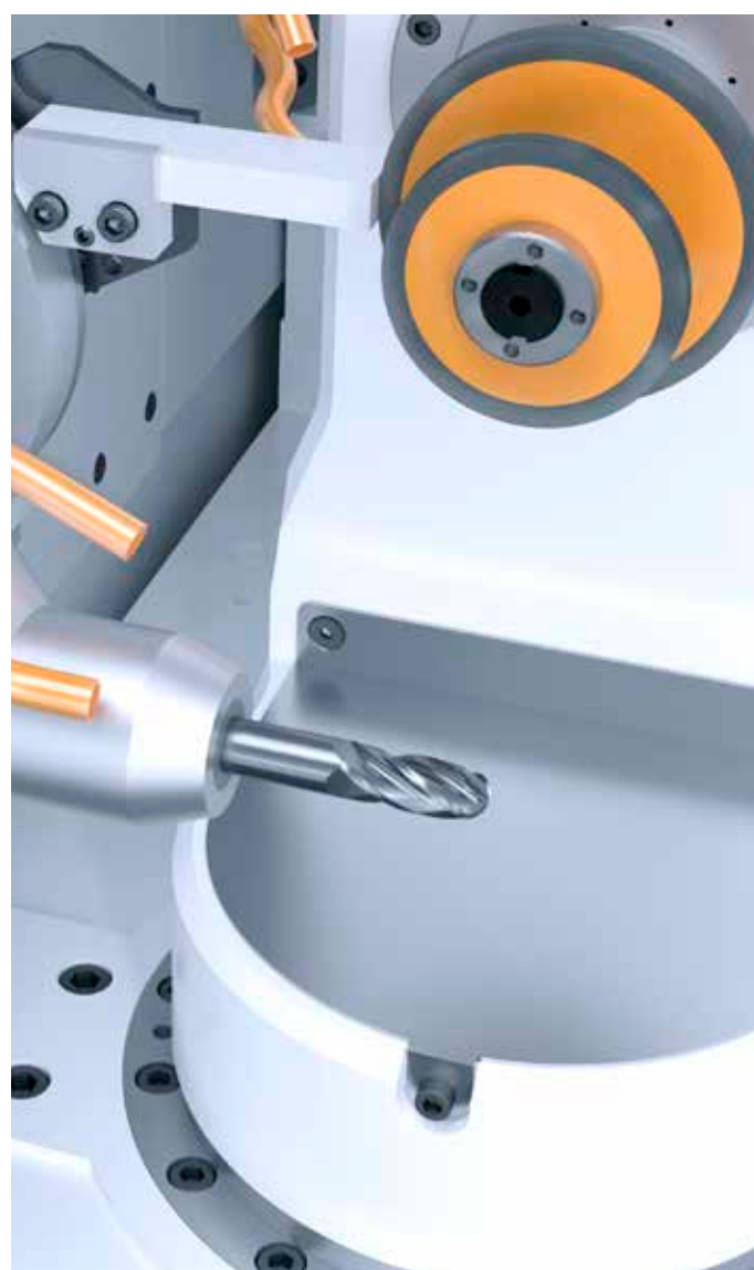
/// PRZYSTAWKA DO OBCIĄGANIA ŚCIERNIC umożliwiająca otwarcie okładziny szlifierskiej
