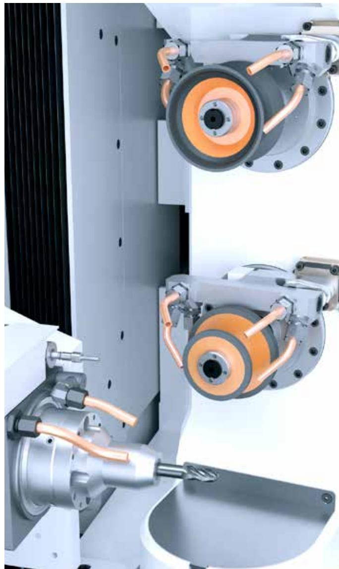
/// 冷却液喷嘴确保理想的切削液供应
