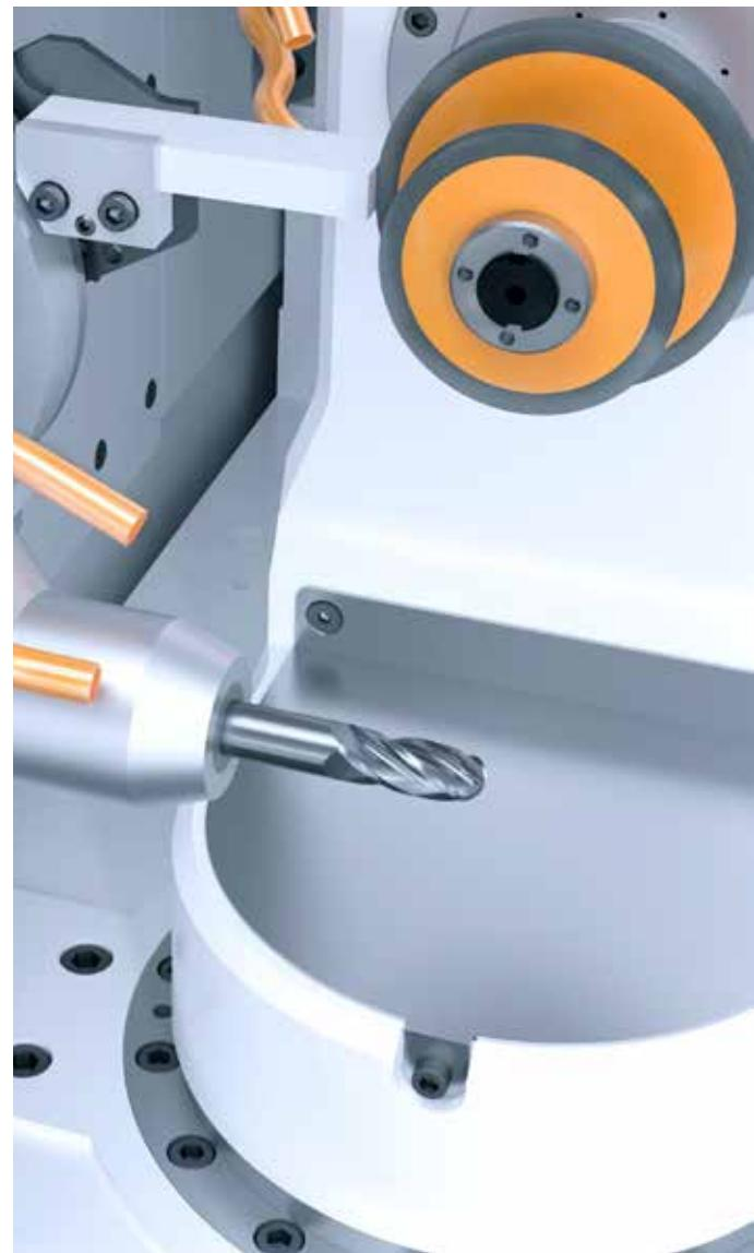
/// 砂轮表面修整，用于锐化磨料层
