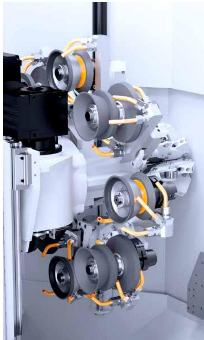
/// 含切削液喷淋管8工位砂轮库
