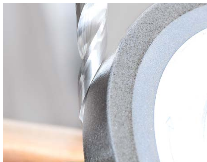
/// AFIAÇÃO do canal em uma broca com ponta em PCD
