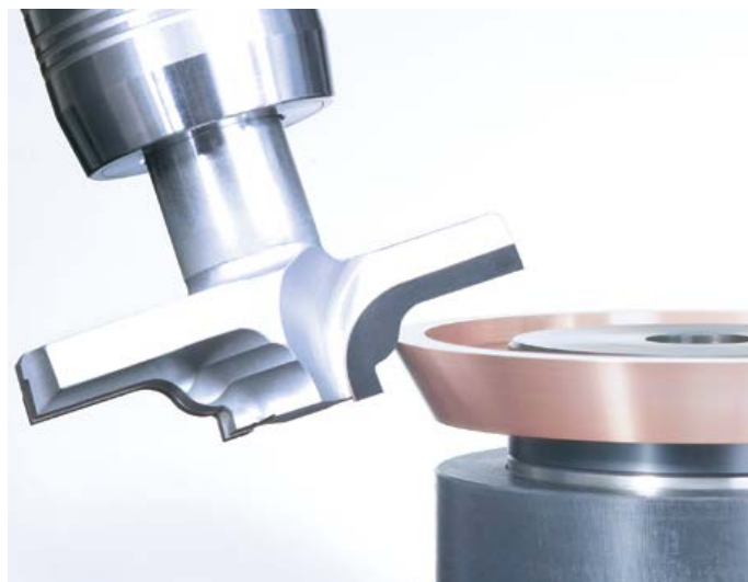
/// EROSÃO DE UMA FRESA PERFILADA
