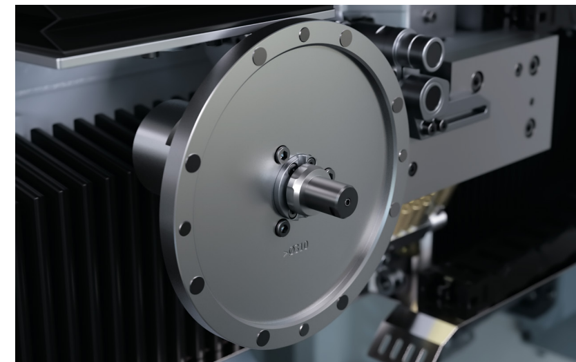
//////// FREIO CENTRAL para serras circulares com revestimento
