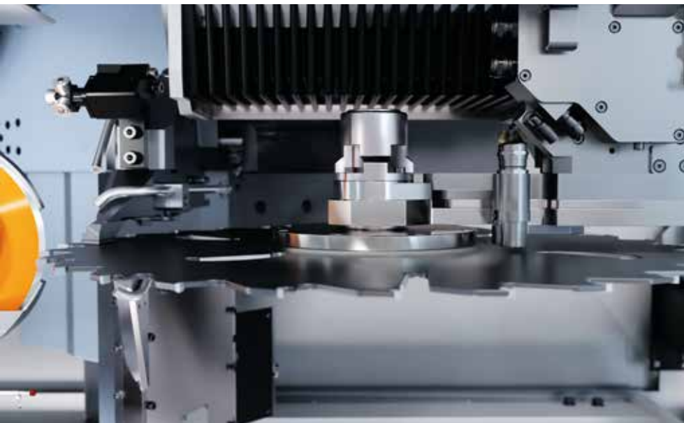
////// RÉGLAGE TRANSVERSAL CONTRÔLÉ usinage automatique de lames de scie avec corps renforcé
