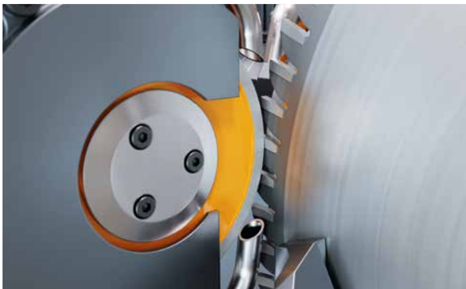
///// RECTIFICATION DES FLANCS
