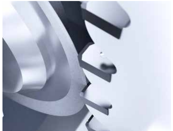
/// SPANTEILERBEARBEITUNG mit 125 mm Schleifscheibe
