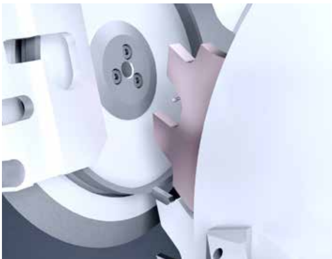
/// FREIFLÄCHENBEARBEITUNG an Spanersegment aus der Sägewerksindustrie
