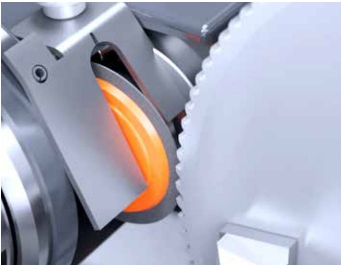
/// SPANTEILERBEARBEITUNG AN SÄGEN mit 50 mm Schleifscheibe
