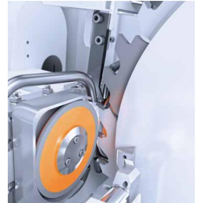
/// BEARBEITUNG EINES SPANERSEGMENTS aus der Sägewerksindustrie
