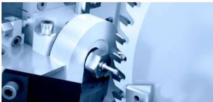
/// SZLIFOWANIE Z BÓW WKLĘSŁYCH dla uzyskania lepszych rezultatów w przemyśle meblarskim
