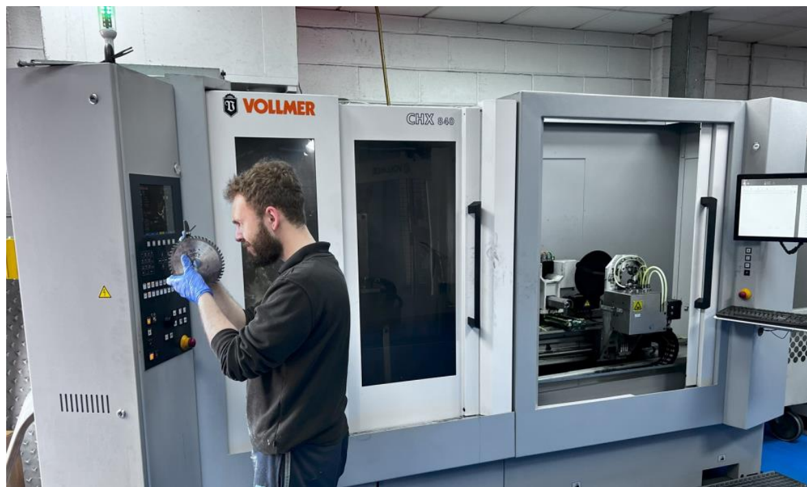
Bildtext: Für die präzise Schärfe von HM-Kreissägen sorgen beim südenglischen Werkzeughersteller Allied Tooling mehrere Vollmer Schleifmaschinen aus der CHD- und CHX-Reihe.
