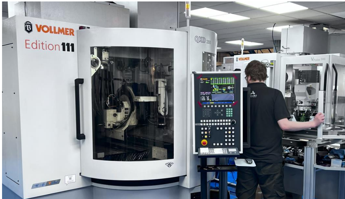
Bildtext: Der südenglische Werkzeughersteller Allied Tooling schärft seine PKD-Werkzeuge hochpräzise mit den Vollmer Scheiben- und Drahterodiermaschinen QXD 250 und VPulse 500.
