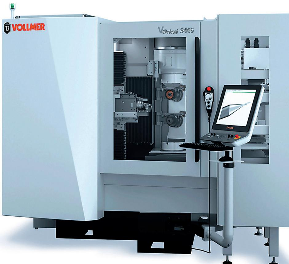
Die 5-Achs-Schleifmaschine VGrind 340S schleift Hartmetallwerkzeuge ab  $\varnothing 0,3$  mm. Zugänglichkeit zum Arbeitsraum und Bedienbarkeit sind optimal.
