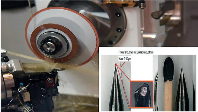
Beim Maschinencheck wurde ein HM-Kleinwerkzeug geschliffen mit einem Eckenradius von 0,04 mm. Max. Radiusabweichung: 0,0004 mm.
