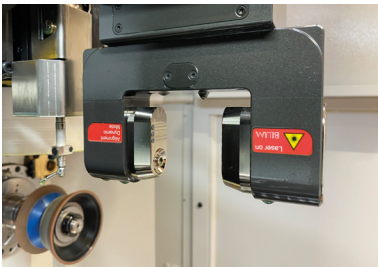
// CLOSED LOOP BEIM RUNDERODIEREN zum Erreichen der engen Durchmessertoleranzen
