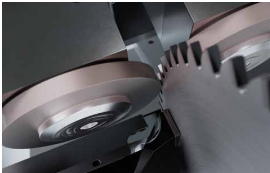
//////// MECANIZADO DE FLANCOS
