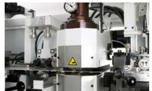
Spann- und Richtstation
