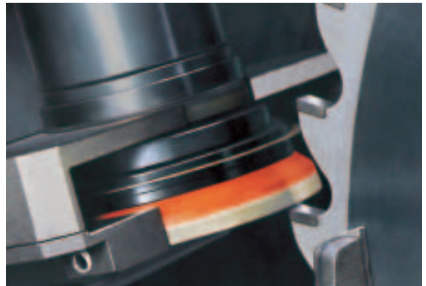
Spanfläche mit negativem Spanwinkel
