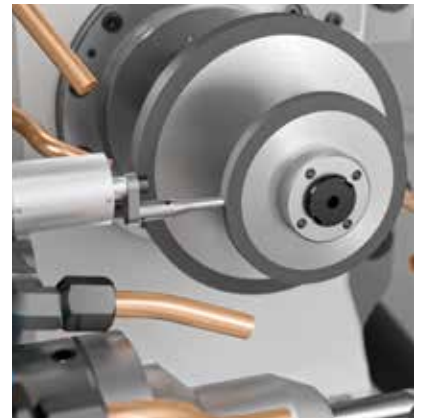
//////// PONTA DE MEDIÇÃO DE DISCOS medição de rebolos e controle do desgaste
