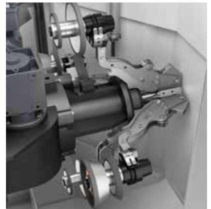
//////// 4-RAMIENNY WYMIENNIK ŚCIERNIC do efektywnej zmiany ściernic i redukcji czasów przejściowych
