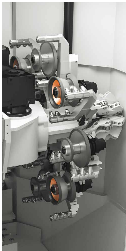
//////// 8 連研磨砥石チェンジャー クーラントノズル交換にも対応
