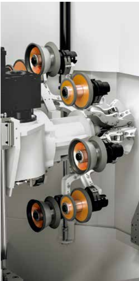
//////// CAMBIADOR DE MUELAS ABRASIVAS DE 8 POSICIONES para un eficiente cambio de herramienta y reducción de los tiempos tecnológicos auxiliares
