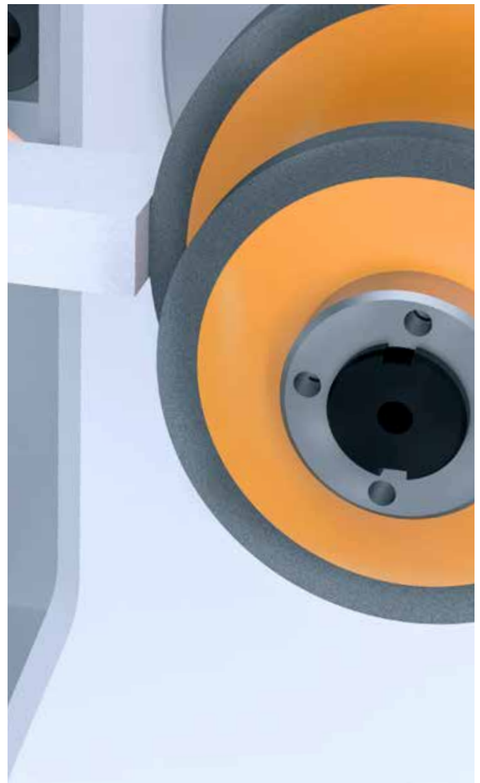
/// ドレッシング (スティッキング) 装置 砥石の目詰まりを除去
