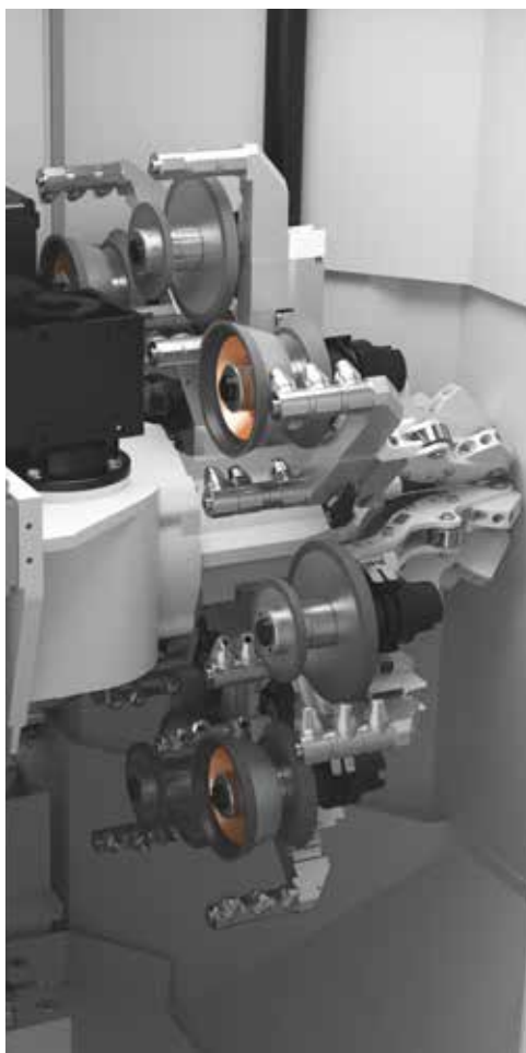
//////// 8-ПАКЕТНЫЙ МАГАЗИН со сменными охлаждающими соплами
