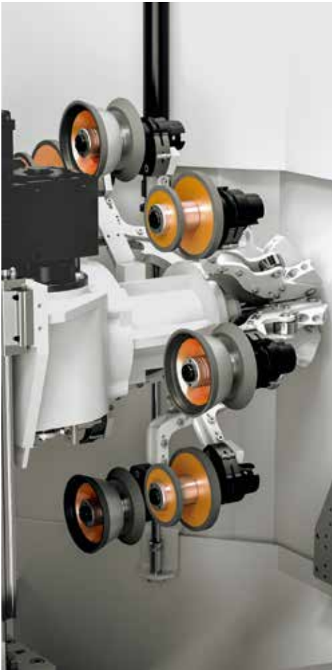
//////// CHANGEUR DE MEULES À 8 POSITIONS pour un changement efficace des trains de meules et une diminution des temps morts
