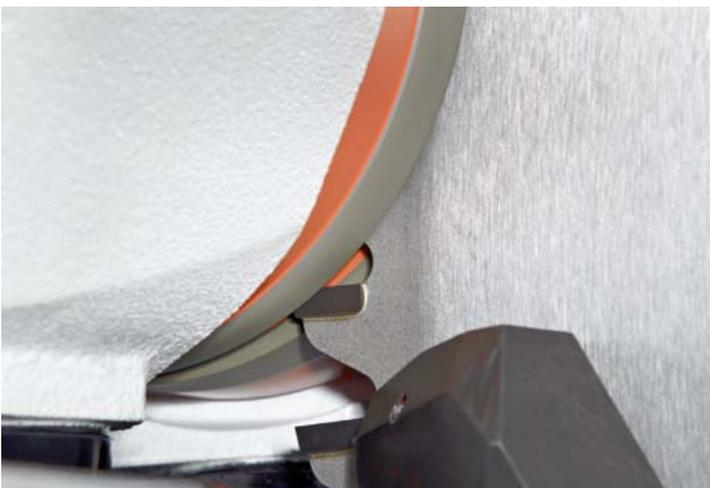
Flankenbearbeitung im Stirnschleifverfahren.
