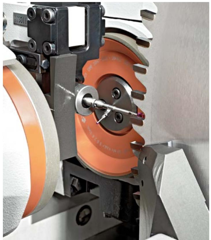
Zwei Schleifspindeln mit dem zentral angeordneten einschwübbaren Messsystem.
