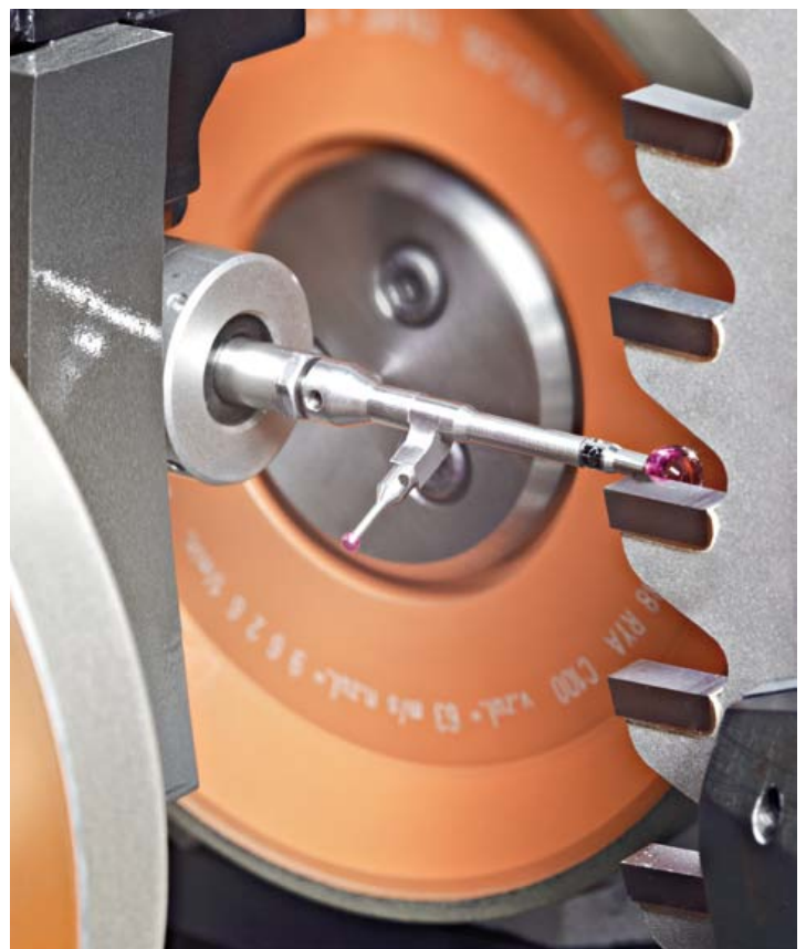
Der standardmäßig integrierte Messtaster nimmt alle relevanten Parameter wie Sägendurchmesser, Spanwinkel, Stammblattdicke, Überstand und Flankenfreiwinkel auf.
