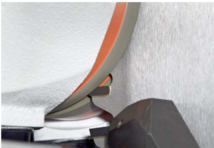
Flankenbearbeitung im Stirnschleifverfahren.
