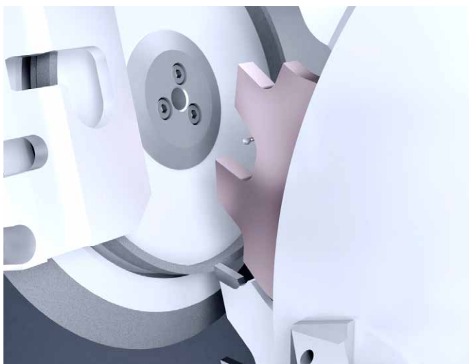
/// LAVORAZIONE DEL DORSO di lame a settori nel comparto segherie
