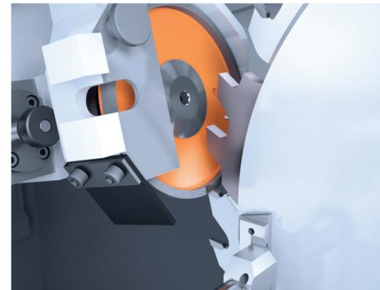
/// MECANIZADO DE SUPERFICIES LIBRES en segmento de arranque de virutas de la industria de aserraderos
