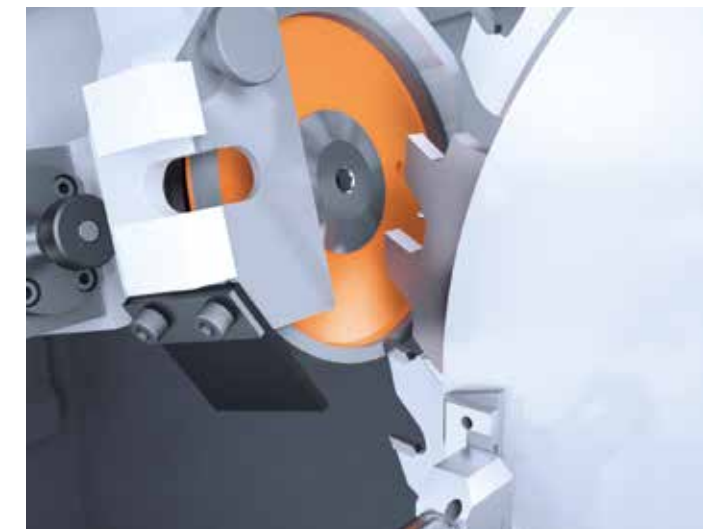
/// FREIFLÄCHENBEARBEITUNG an Spanersegment aus der Sägewerksindustrie
