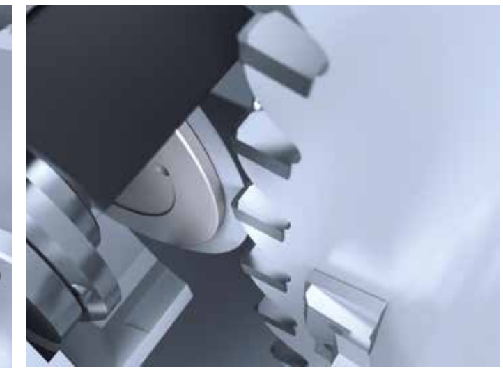
/// SPANTEILERBEARBEITUNG mit 125 mm Schleifscheibe
