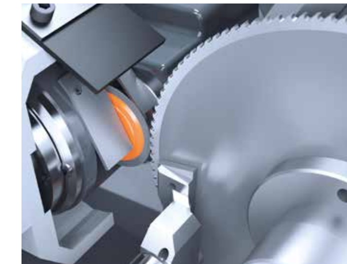
/// SPANTEILERBEARBEITUNG AN HSS-SÄGEN mit 50 mm Schleifscheibe
