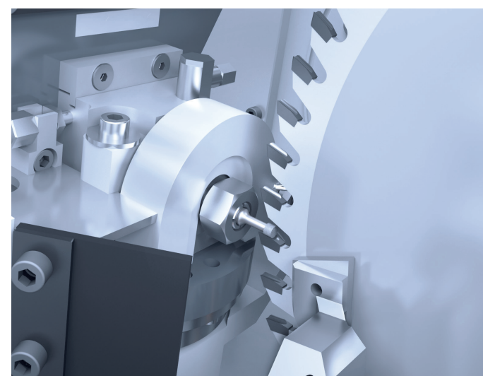
/// 齿面凹凸刃磨 实现家具制造业的最佳质量
