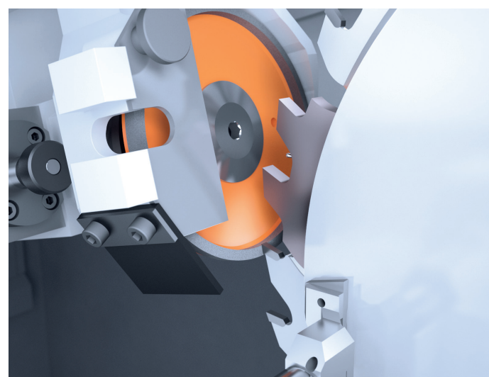
/// 齿顶刃磨 针对锯木业的掉齿现象
