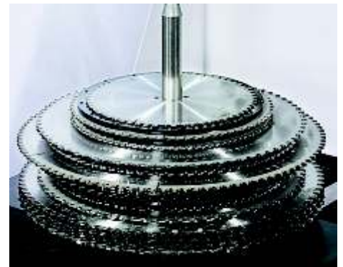
Na każdym z wózków załadunkowych może być magazynowane do 50 pił HM o różnych średnicach i geometriach zębów
