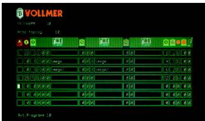
Parametry pracy centrum szlifierskiego mo na wprowadza bezpo rednio z panelu kontrolnego magazynu.
