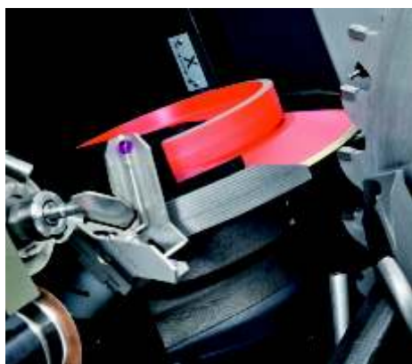
Ostrzenie kąta negatywnego od strony natarcia.
