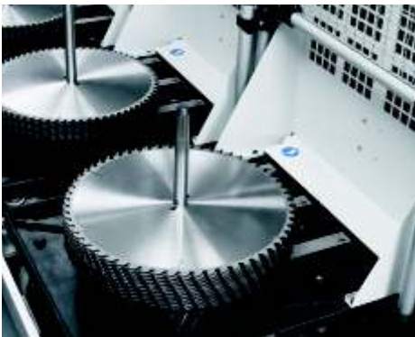
Wózek załadunkowy z pojedynczym stosem pił w trybie produkcyjnym.
