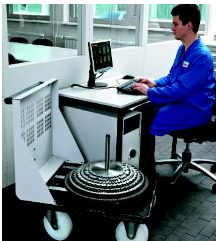
Stosy pił s przygotowywane i programowane poprzez zewn trzn stacj wprowadzania danych, np.w wydzielonym pomieszczeniu ostrzalni.
