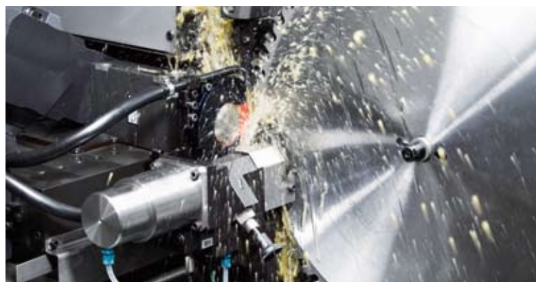
Lavorazione dei fianchi
