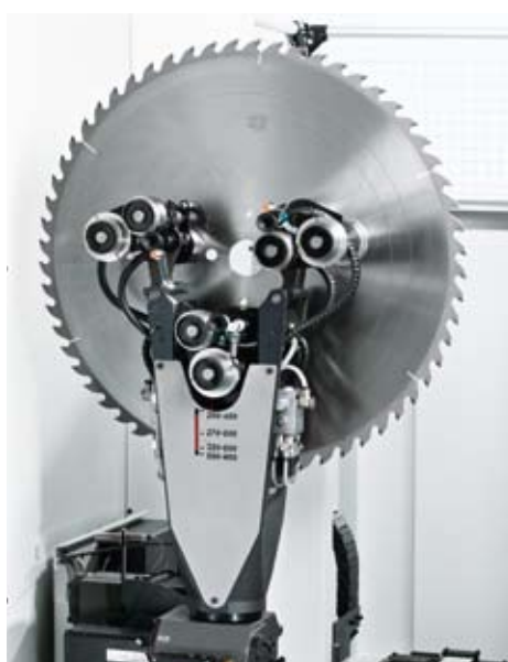
Preso standard per für ND 320/340/360. Per l'automazione di lame con diametro fino a 840 mm e 20 kg di peso.
