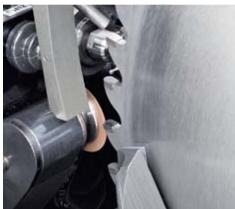
Lavorazione del canalino rompitruciolo.
