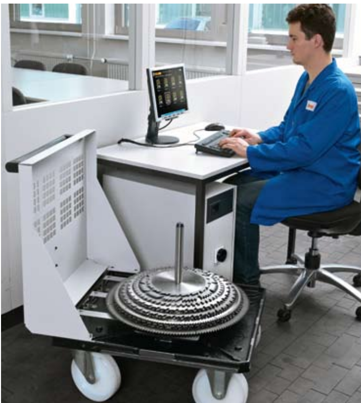
Alla stazione di inserimento dati le pile di lame vengono preparate e programmate.
