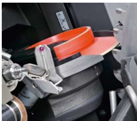
Lavorazione della superficie con angolo negativo.
