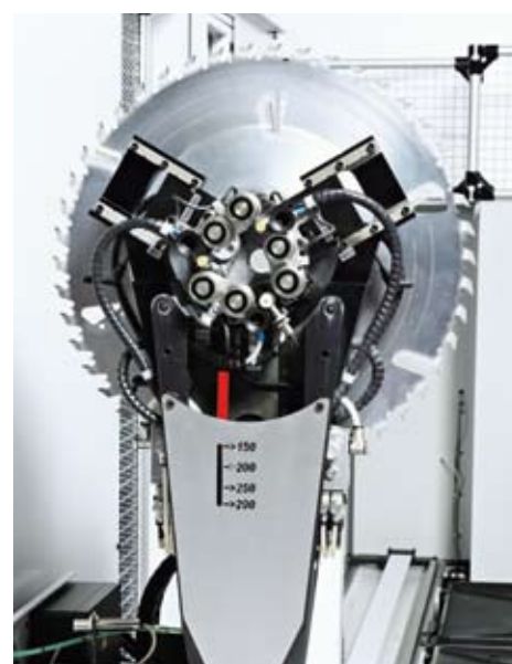
Preso specifica per le lame con offset. Adattabile ad entrambi i sistemi di caricamento.
