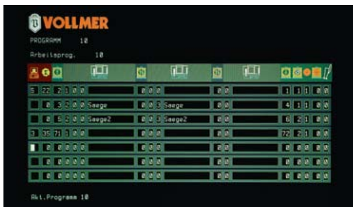
Suivant le besoin, peuvent être élaborés divers programmes et piles de lames pour l'usinage des faces d'attaque et de dépouille ainsi que des flancs.
