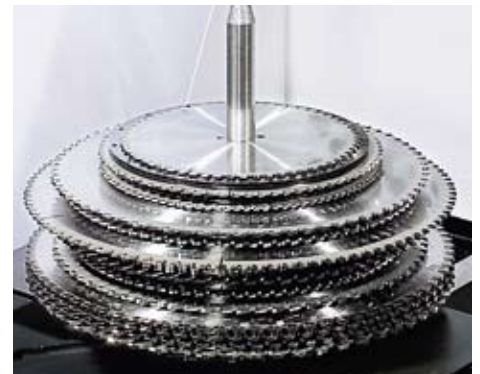
Sur chaque chariot, peuvent être déposées jusqu'à 50 lames carbure de diamètres et de géométries de dents différents.
