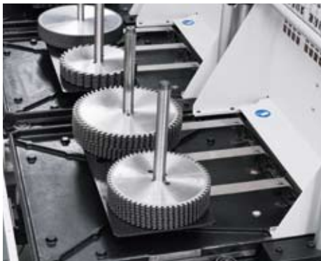
2 piles de lames sur un chariot pour augmenter la capacité de chargement.
