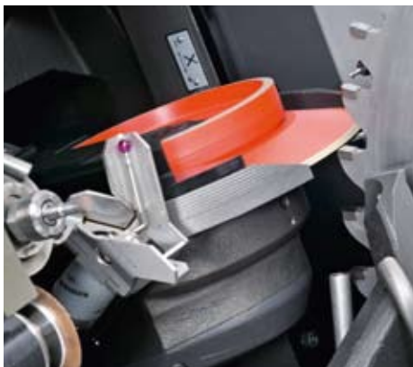
Bearbeitung der negativen Spanfläche.
