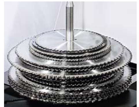
Auf jedem Beladewagen können bis zu 50 HW-Sägeblätter mit unterschiedlichen Durchmessern und Zahngeometrien abgelegt werden.
