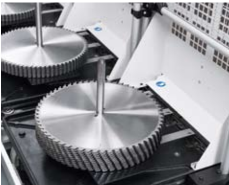
Beladewagen mit einem Sägeblattstapel im Produktionsmodus.
