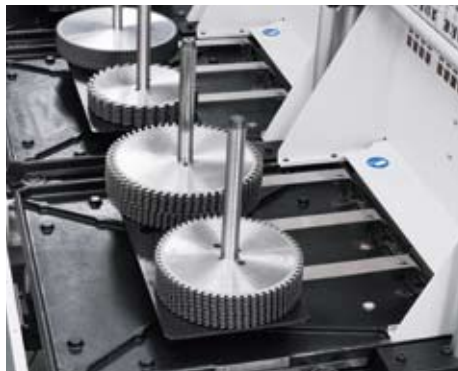
Zwei Sägeblattstapel auf einem Beladewagen zur Erhöhung der Beladekapazität.
