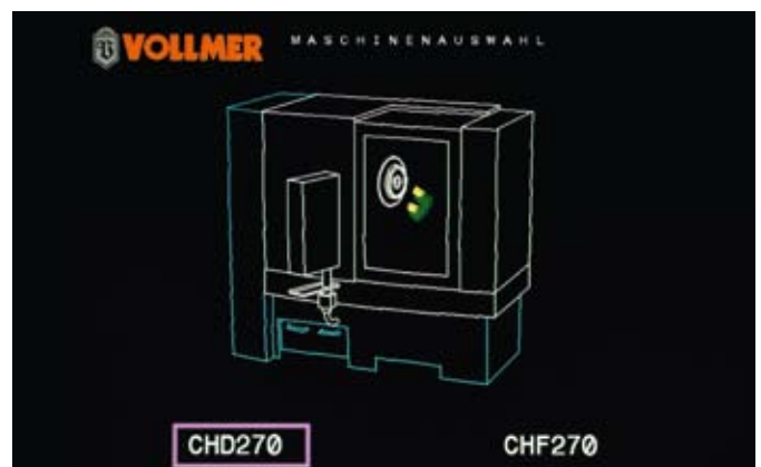
Je nach Anforderung können verschiedene Arbeitsprogramme und Sägeblattstapel für die Bearbeitung der Span- und Freifläche sowie der Flanken erstellt werden.
