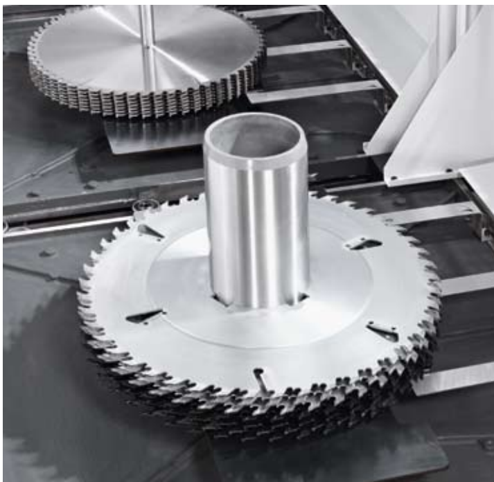
Sägeblattstapel auf Beladewagen ND 320/340/360.
