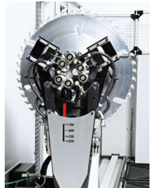
Speziell entwickelter Greifer für das Handling von Sägeblättern mit Bund. An beide Handlingsysteme anbaubar.
